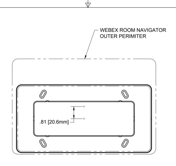
SHOWN HERE IS THE 4 GANG ELECTRICAL BOX, WALL MOUNT PLATE, IN RELATION TO THE OUTLINE OF THE WEBEX ROOM NAVIGATOR. THE DISTANCE FROM THE CENTER OF THE SCREEN TO THE CENTER OF THE ELECTRICAL BOX IS ALSO ILLUSTRATED.
