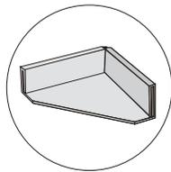
**1.** Doble los dos (2) Esquineros Guías y déle forma como se muestra en la figura. Volteélos y aplíquelos a las esquinas con las cintas de espuma adhesivas de doble cara. Presione las tiras hacia abajo con firmeza. Quite la cinta protectora.
