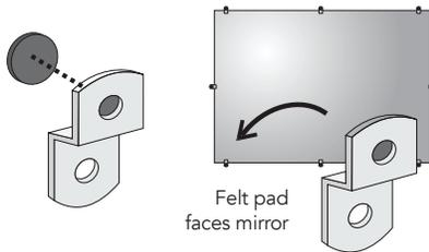
**3** Ciertos clips de plástico grandes no funcionan bien con los marcos MirrorMate. Si sus clips impiden que el marco quede completamente a ras con el espejo, reemplace los clips viejos uno por uno por los clips de repuesto que ordenó. Asegúrese de que estos nuevos clips estén bien anclados a la pared, preferiblemente al muro de entramado.
