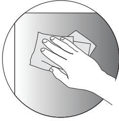
**1** Deje que el marco se seque por los menos una media hora. Mientras el marco se seca, limpie el perímetro del espejo con alcohol isopropílico y déjelo secar por cinco (5) minutos para que la cinta de montaje adhesiva se adhiera correctamente. NO utilice ningún otro agente de limpieza ya que dejará un residuo.
