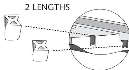
**1** Coloque las 4 secciones del marco BOCA ABAJO en la posición que se muestra en la figura. Debajo de cada esquina, coloque alguna cosa plana desechable la cual no importe si se unta de pegante (por ejemplo: un pedazo de cartón, un trapo, o papel encerado).
