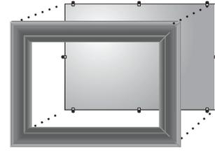
**2** Lleve el marco al espejo. Pruebe el ajuste del marco sobre los clips. El marco debe cubrir completamente la superficie del espejo de manera uniforme en todos los lados y quedar al ras. (Si los clips no encajan en el canal en la parte posterior del marco, siga al paso número 3.) Si el marco hace contacto completamente con el espejo, continúe al paso número 4.
