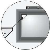
**2.** Cuando el marco esté colocado donde lo desea, pídale a su ayudante que presione firmemente los Esquineros Guías (marcados como izquierda "left" y derecha "right") en ambas esquinas superiores interiores del marco, como se muestra en la figura. Presione firmemente contra el espejo. Si a usted se le envió un tercer (3er) Esquinero, colóquelo en el medio.
