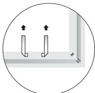
**3.** Hale las cintas dobladas con las que formó las esquinas hasta pelarlas completamente. Asegúrese de halar en la dirección de la cinta restante. Empuje firmemente con sus manos a lo largo de toda la superficie del marco para fijarlo de forma permanente. ¡Ahora tiene un hermoso espejo enmarcado!
