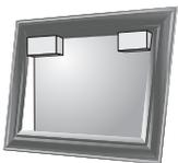
**12** Sin tocar el marco con el espejo, **guíe el marco en su lugar** utilizando los bloques de esquina de colocación. Empuje el marco hacia el espejo comenzando por el borde superior. Pase firmemente sus manos a lo largo de toda la superficie del marco para fijarlo permanente.
