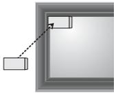
**10** Cuando el marco esté donde lo desee (use un nivel si lo desea), **aplique presión a los bloques de esquina de colocación** en ambas esquinas interiores superiores del marco, como se muestra. Si le enviaron una 3ra esquina, colóquela en el medio. Puede reposicionarlos según sea necesario.
