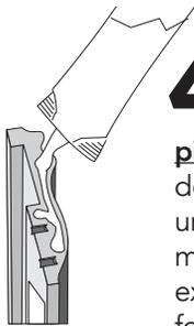
**4** Una esquina a la vez, **aplique pegamento ligeramente a una pieza** y extienda una capa delgada de manera uniforme. Coloque el marco plano. Alinee los extremos pegados para formar la primera esquina.
