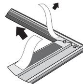
**11** Mientras deja las esquinas de colocación en el espejo, baje el marco y **retire el respaldo de la cinta del marco.**
