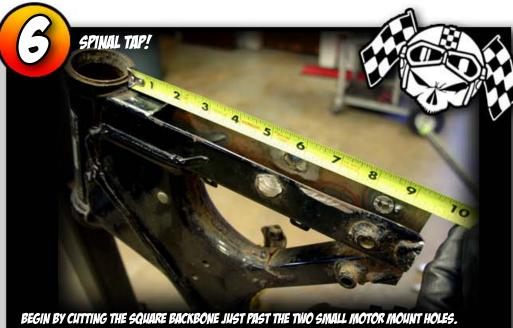
BEGIN BY CUTTING THE SQUARE BACKBONE JUST PAST THE TWO SMALL MOTOR MOUNT HOLES.
