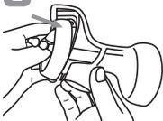
วางแผ่นยางรองครอบบนตัวปั้ม กดขอบด้านล่างของแผ่นยางรองให้เข้าในร่องของตัวปั้มให้สนิท หากกดไม่สนิทอากาศจะสามารถไหลผ่านเข้าตัวเครื่องได้ ทำให้แรงดูดไม่ทำงาน
