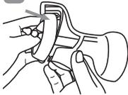
Letakkan diafragma pada bagian atas badan pompa. Pasanglah sisi bagian bawah diafragma dengan benar pada lekukan badan pompa. Jika tidak terpasang dengan benar maka akan terjadi kebocoran udara dan daya hisap pada pompa ASI akan tidak maksimal.
