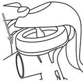
Tekan bagian bertanda "PUSH" pada gagang untuk mengatur lubang dengan tingkatan atas atau bawah yang terdapat pada stem.
