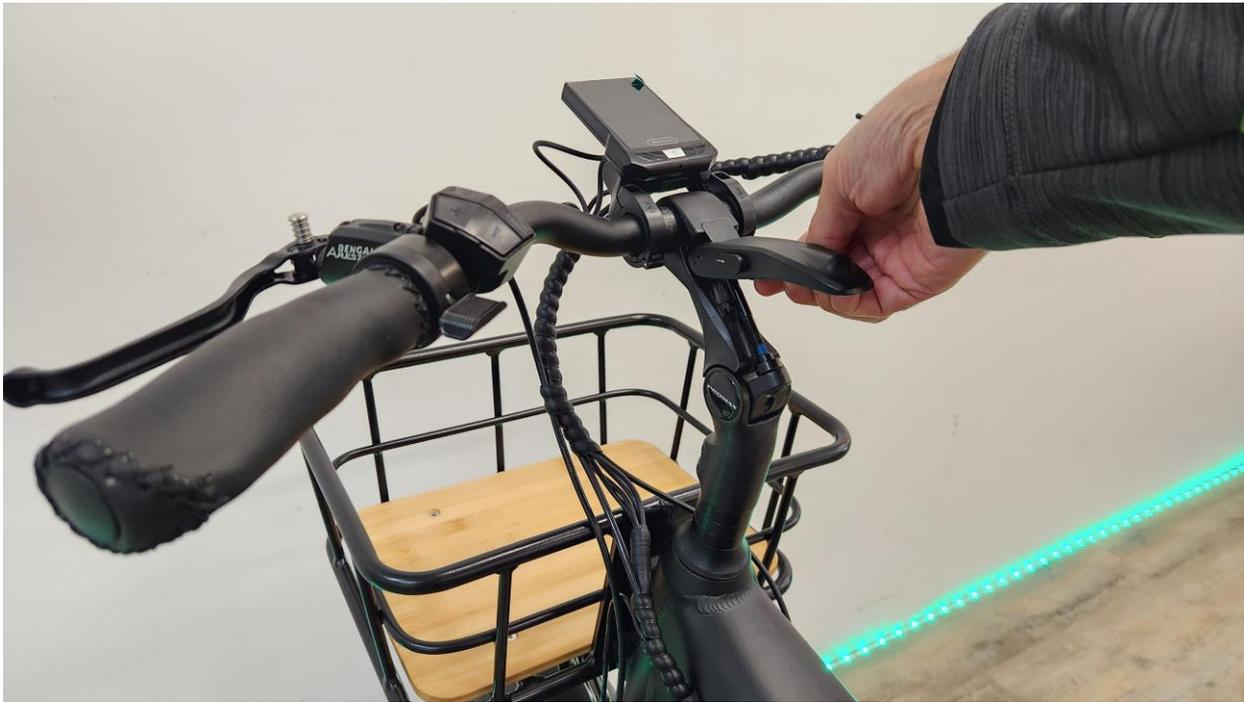
*Photo A – Levier de verrouillage du guidon en position ouverte et déverrouillée*
