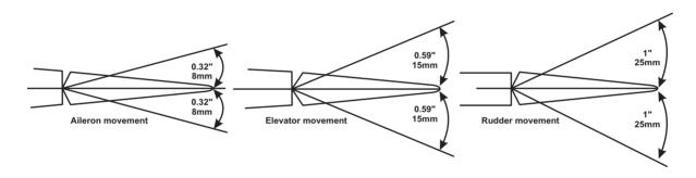
High rate Low rate **ELEVATOR** 0.59"( 15mm ) up 0.4"( 10mm ) up 0.4"( 10mm ) down 0.59"( 15mm ) down **RUDDER** 0.8"( 20mm ) right 1"( 25mm ) right 1"( 25mm ) left 0.8"( 20mm ) left **ALERON** 0.32"(8mm) up 0.24"(6mm) up 0.24"( 6mm ) down 0.32"(8mm) down
