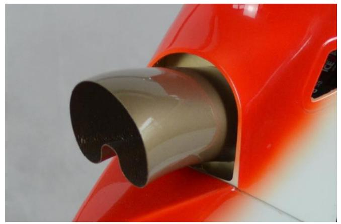
将排气管隔框和排气管调整好位置后先用瞬间胶固定后，用环氧树脂与机身粘接
