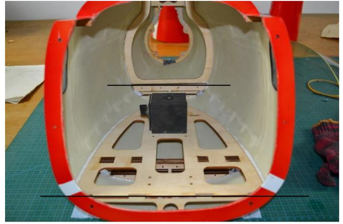
先将前隔框与机身粘接牢固，然后将组装好的木质底座和后隔框放入机身用环氧树脂粘合，并用重物压住，等待固化。请注意照片上黑色线之间的平行关系
