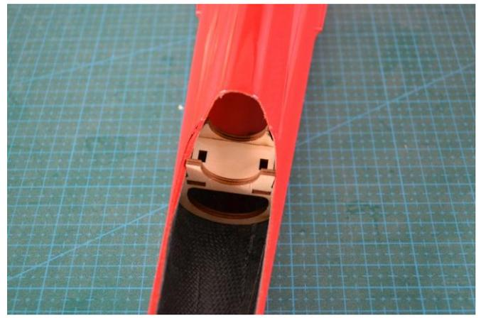
将尾管隔框 按图组装并放置到位 注意图示的尺寸
