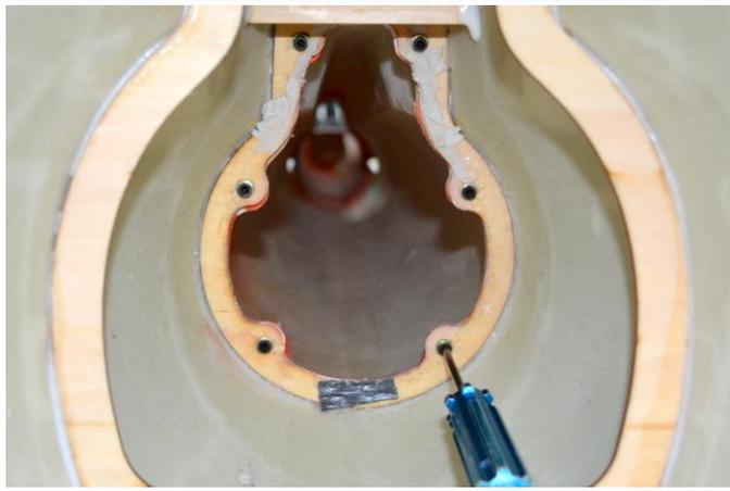
参考图示将机身中段与后段 用 螺丝连接起来。
