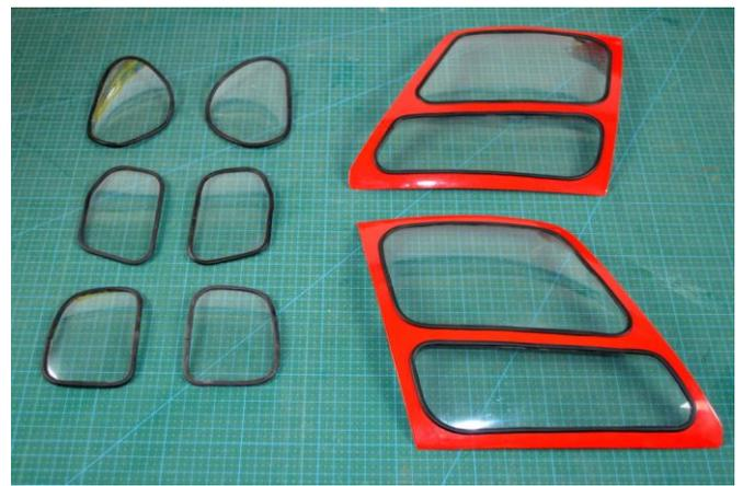
将粘好密封条的 玻璃安装到 窗框上。
