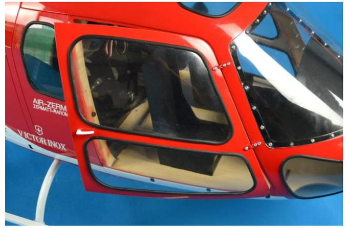
将大约裁好的 风挡玻璃用胶带预固定在机身上，然后用细的纸胶带沿着黑色的窗框位置贴出一圈。然后沿着贴出的位置裁剪好。再在需要上螺丝的位置 做好标记 用 1mm 的钻头钻孔，用 1.4\*3 的小自攻螺丝固定
