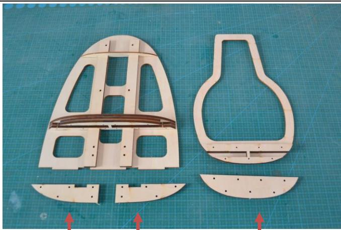
请按照照片所示将木质底座的零件粘合到一起注意务必保证孔位对齐。
