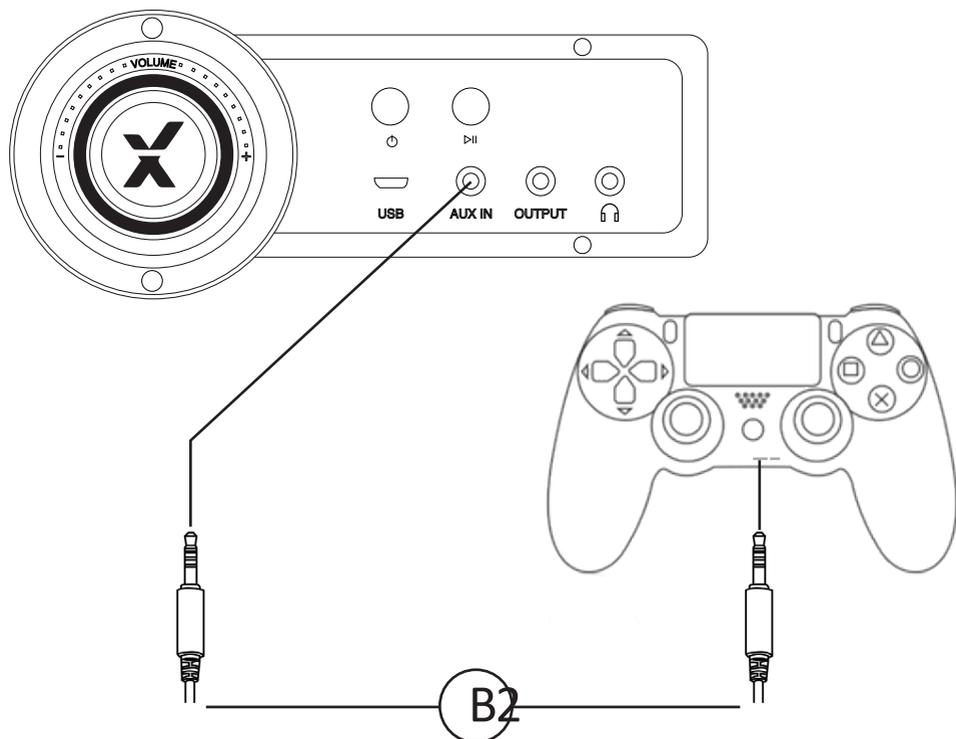
1. Connectez le câble B2 à la prise d'entrée 3.5mm du panneau de commande XRocker
