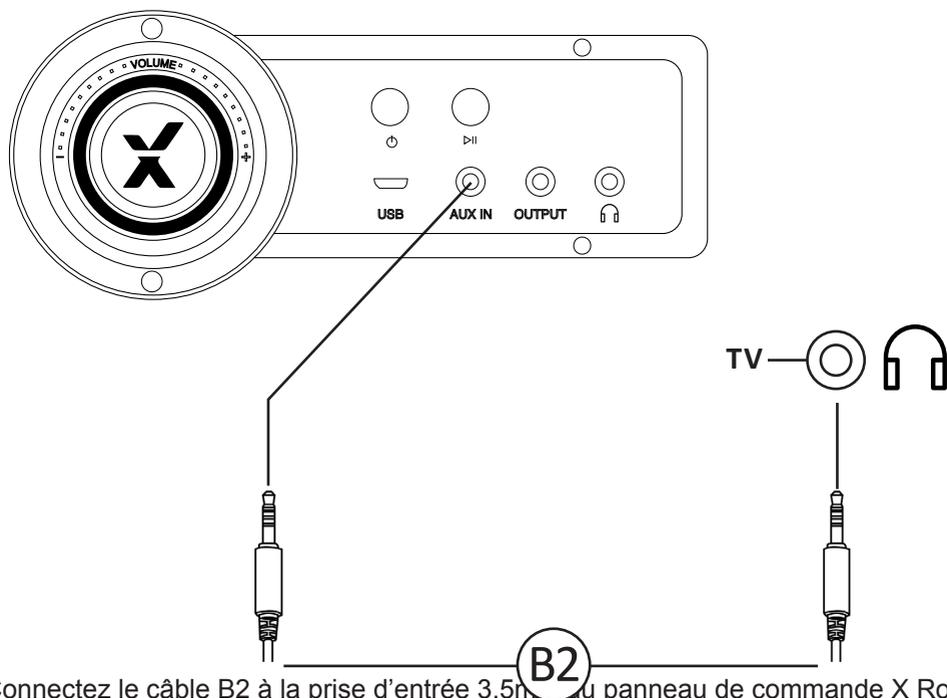
1. Connectez le câble B2 à la prise d'entrée 3.5mm du panneau de commande X Rocker
