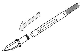
Démonter le convertisseur et le bloc-plume et remonter les deux pièces ensemble.
