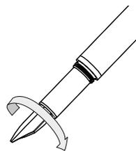
Monter le bloc-plume en vissant dans le sens des aiguilles d'une montre.
