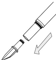
Retirer et remplacer par le bloc-plume souhaité.
