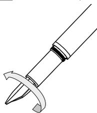
Dévisser le bloc-plume dans le sens inverse des aiguilles d'une montre en le tenant fermement.
