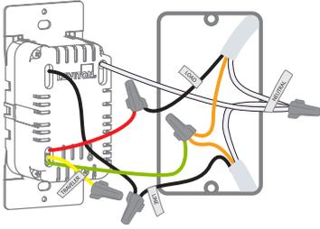
3-Way Wiring Diagram
