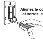
Alignez le contrôle et serrez les vis.
