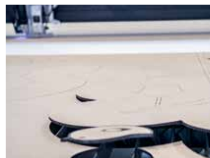
Laserschneiden von Möbeln aus MDF - vom Design zum fertigen Produkt in wenigen Augenblicken
