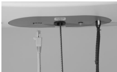
Figure 3 : Connecteur de la télécommande avec crochet de verrouillage inséré dans le connecteur du lève-personne
