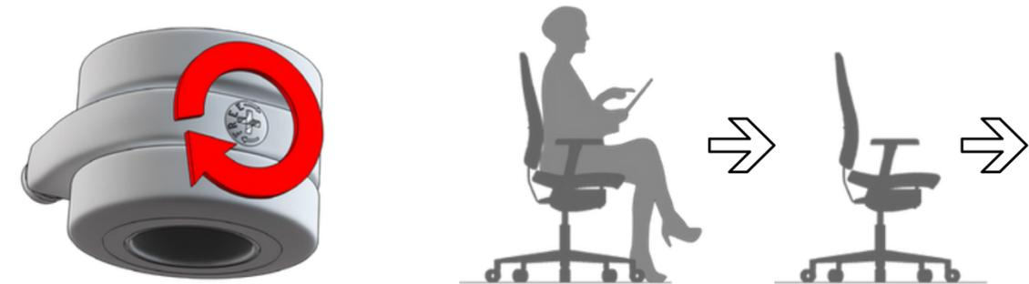
Usando un destornillador de punta de estrella, y girando el tornillo en el sentido de las agujas del reloj, dejamos la rueda libre. Tanto con el usuario sentado o la silla sin usuario, la rueda gira libremente y la silla se puede mover.
