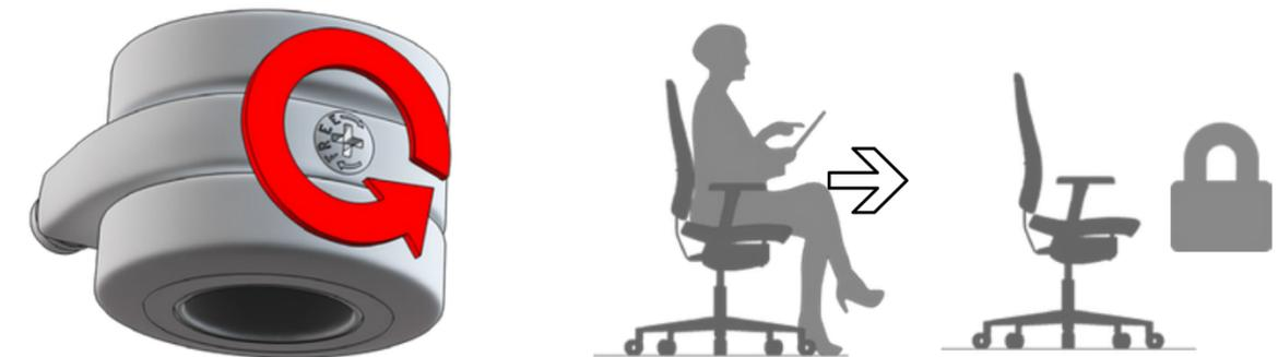
Con sistema de freno de seguridad ajustable que permite que la silla esté ligeramente frenada cuando nos levantamos del asiento, a fin de evitar que la silla se desplace cuando se deja de utilizar. Con el usuario sentado, la rueda gira libremente y la silla se puede mover. Con la silla sin usuario, sin peso, la rueda ejerce resistencia al movimiento. Dispone en la parte inferior de un tornillo para ajustar la fuerza del frenado o la desactivación del mismo.
