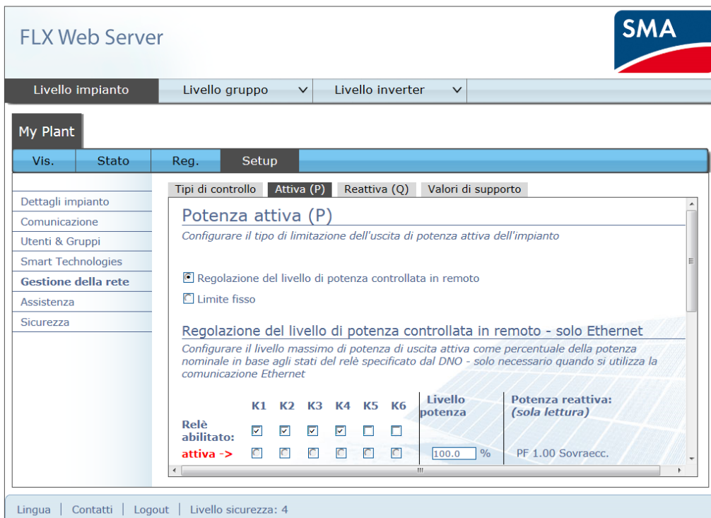
Disegno 2.2 Configurazione del controllo della potenza attiva - PLA
