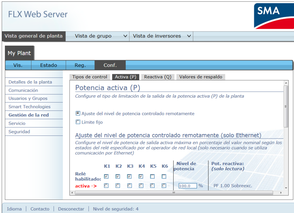
Ilustración 2.2 Configuración del control de potencia activa: ajuste del nivel de potencia (PLA)
