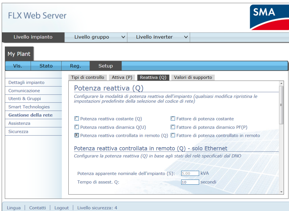
Disegno 2.3 Configurazione del controllo della potenza reattiva
