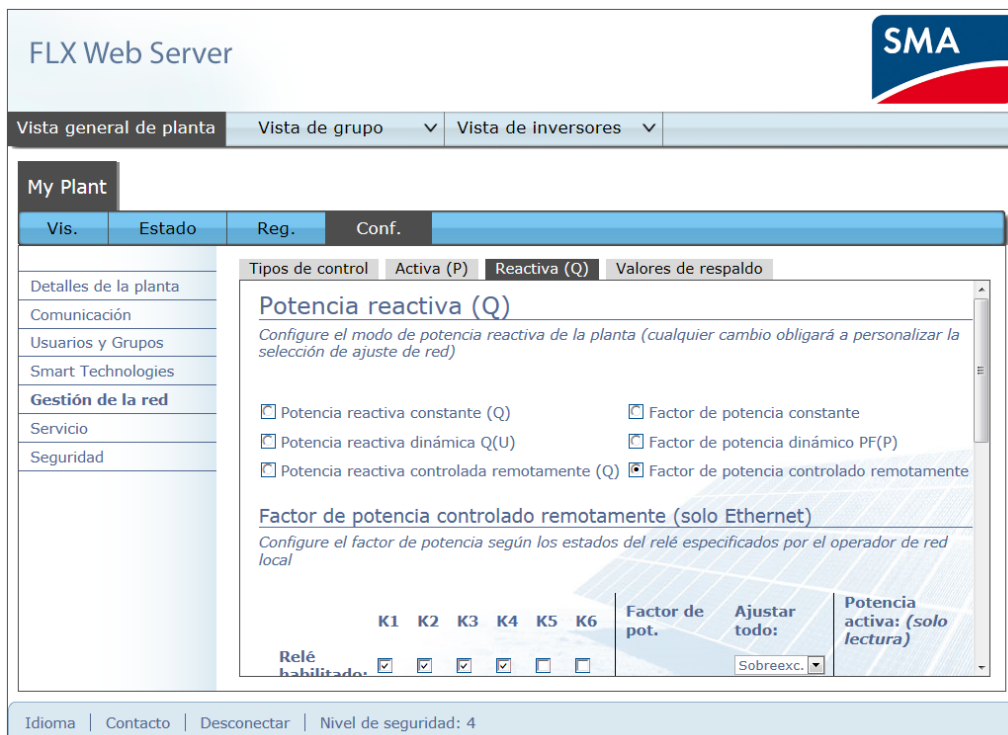
Ilustración 2.4 Configuración del factor de potencia
