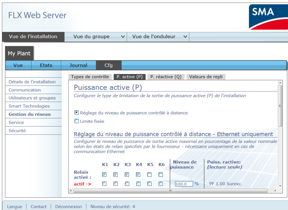
Illustration 2.2 Configuration du contrôle de puissance active – PLA
