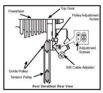
Figure D2: Rear Derailleur Rear View.
