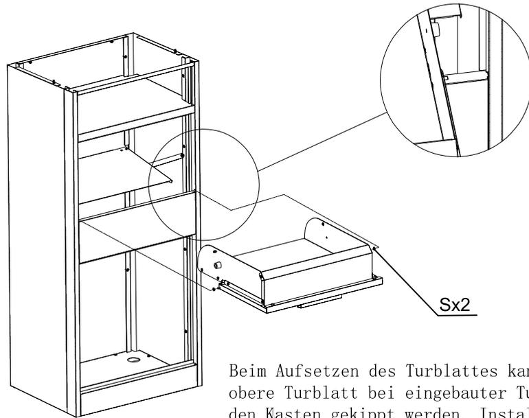
Beim Aufsetzen des Turblattes kann das obere Turblatt bei eingebauter Tur in den Kasten gekippt werden. Installieren Sie zuerst die rechte Seite, dann die linke Seite.
