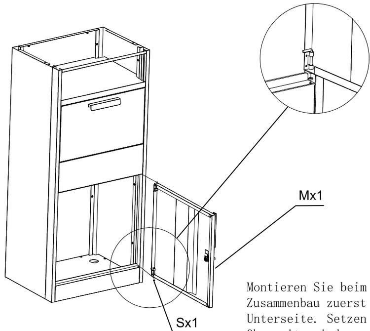
Montieren Sie beim Zusammenbau zuerst die Unterseite. Setzen Sie die Oberseite wieder zusammen.
