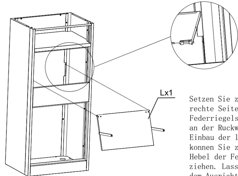
Setzen Sie zuerst die rechte Seite des Federriegels in das Loch an der Rückwand ein. Beim Einbau der linken Seite können Sie zuerst den Hebel der Federklinke ziehen. Lassen Sie nach dem Ausrichten mit dem Loch den Hebel los. Die Montage ist abgeschlossen.
