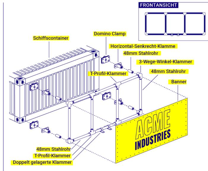
Erzeugt einen rechteckigen Rahmen mit einer Innenöffnung von 2,45m(H) x 5,8m(B)
