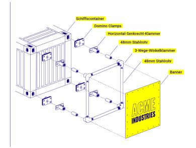
Erzeugt einen fast quadratischen Rahmen mit einer Innenöffnung von 2,2 m (B) x 2,35 m (H)
