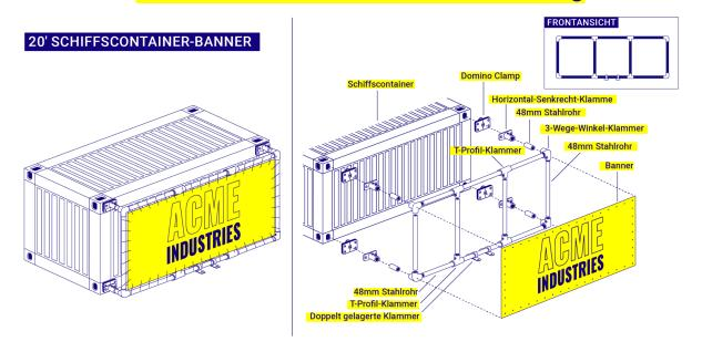
Erzeugt einen rechteckigen Rahmen mit einer Innenöffnung von 2,45m(H) x 5,8m(B)
