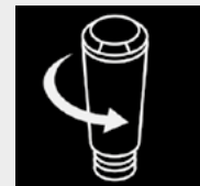
Выкручивание фильтра из бака для воды
