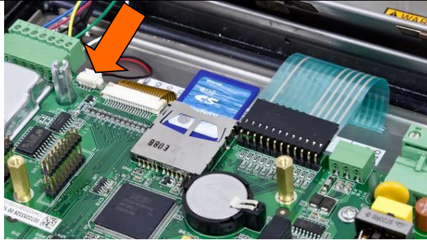
Figura 5-7: Inserimento scheda di memoria SD
