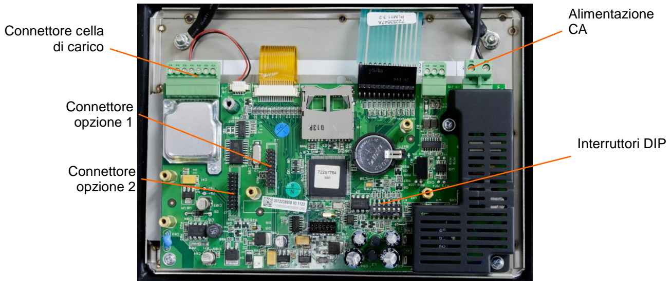
Figura 1-5: Collegamenti scheda madre T72XW, modello CA
