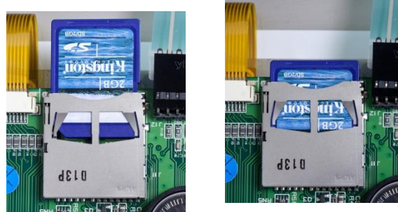
Figura 1-10: Inserimento di una scheda SD nella presa SD (sinistra); scheda SD installata (destra)
