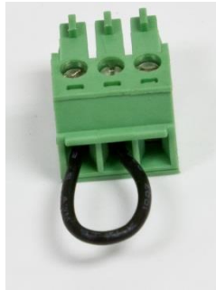
Figura 5-4: Ponticello tra i terminali di trasmissione e ricezione COM1
