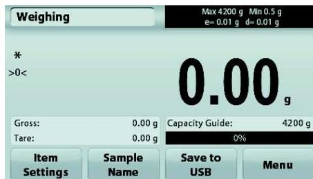
Pantalla principal de la aplicación de pesaje con el LFT en ENCENDIDO.
