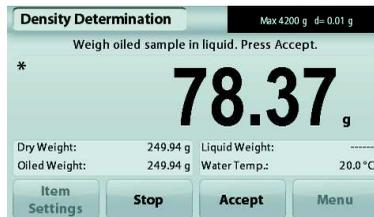
Una vez que se han determinado los pesos necesarios, la densidad de la muestra aparece en **g/cm<sup>3</sup>** (junto con el peso en aire, no lubricada y lubricada y peso en agua) en la pantalla de la aplicación.
