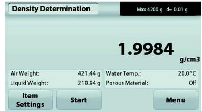
Una vez que se han determinado los pesos necesarios, la densidad de la muestra aparece en **g/cm³** (junto con el peso en aire y peso en agua) en la pantalla de aplicaciones.
