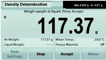
**Paso 2 de 2 – Pesar la muestra sumergida en líquido.**
