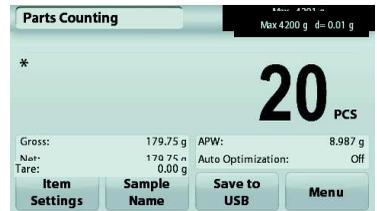
**Optimización automática:** cuando está **Activada**, mejora la exactitud del recuento volviendo a calcular automáticamente el peso de la pieza a medida que se añaden las piezas. De manera predeterminada está **Desactivada**.
