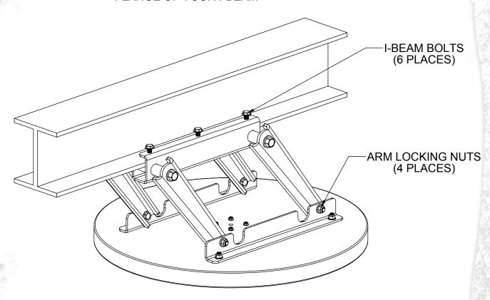
STEP 3: SLIGHTLY TIGHTEN THE SHOWN BOLTS & NUTS AND ADJUST THE HEIGHT OF THE PLATFORM.
