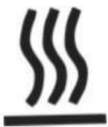
Dieses Zeichen warnt Sie vor Verbrennungs- bzw. Verbrühungsgefahren. Vorsicht! Während des Betriebs strömt heißer Dampf aus dem Dampfventil!
