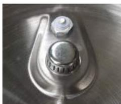
Die Ventilabdeckung befindet sich unter dem Innendeckel des Außendeckels. Nehmen Sie erst den Innendeckel vom Deckel ab. Drücken Sie zum Entfernen die Ventilabdeckung zur Seite und heben Sie diese nach oben ab. Zum Anbringen die Ventilabdeckung nach unten drücken. Achten Sie darauf, dass die Ventilabdeckung immer sauber und frei von Fremdkörpern ist.
