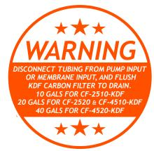
MAKE SURE WATER IS FREE FROM CARBON FINES & DEBRIS BEFORE RECONNECTION TO MEMBRANE INPUT
