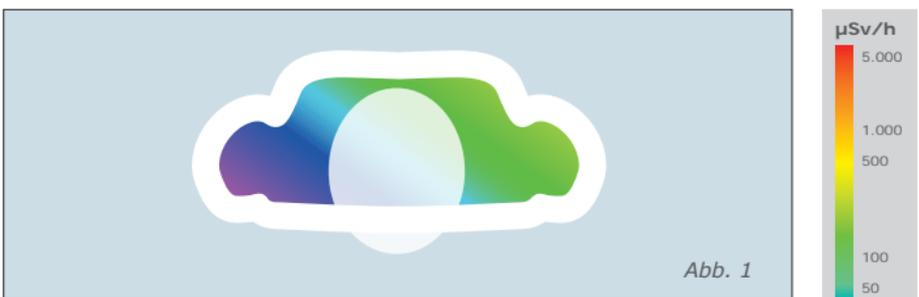
Situation am Untersucher mit neuer Schutzscheibe ohne Lamellenbehang: Der hellblaue Bereich signalisiert eine hohe Strahlenbelastung im Oberkörperbereich infolge der Unterstrahlung der Schutzscheibe.
