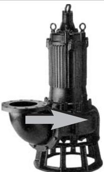
Wenn die Pumpe anläuft, übt Sie einen Ruck entgegen dem Uhrzeigersinn aus (von oben gesehen). Bei falscher Drehrichtung sind zwei der Phasen U, V und W durch einen qualifizierten Elektriker zu vertauschen.
