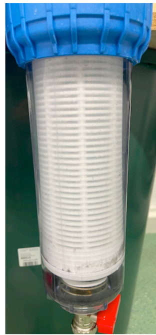
Abbildung 2: Gefüllte Filterkartusche am Ausgang von Prüfmuster 8 nach der dritten Wäsche
