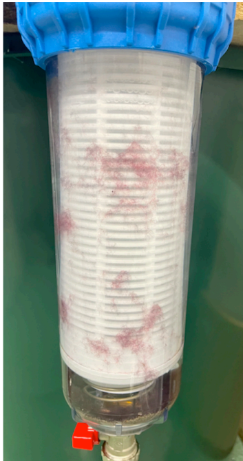
Abbildung 1: Gefüllte Filterkartusche am Eingang von Prüfmuster 8 nach der dritten Wäsche
