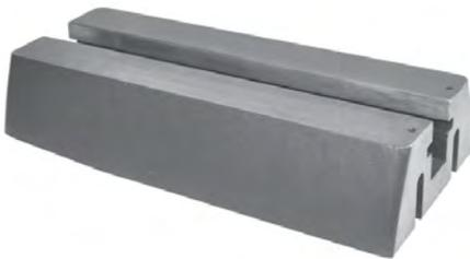
Esta extensión corta de hierro fundido de 13-1/2" se fija con pernos al extremo izquierdo del cabezal fijo del Torno 70-150VSR para torneado exterior. Extiende la capacidad del diámetro de oscilación del torno de 12" a 15-1/2".
