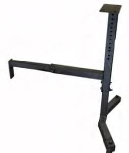
Extensión de la Plataforma universal, completamente de acero. Se atornilla a las plataformas 70-910 y 70-920 para sostener tornos con extensiones de bancada. La extensión de plataforma se ajusta de 18-3/4" a 32-1/4" de largo, y de 24-1/2" a 34-1/2" de altura funcional.
