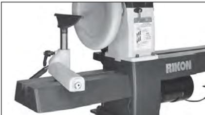
También se encaja en el extremo derecho del cabezal móvil del torno para extender la capacidad del largo del husillo hasta 30".
