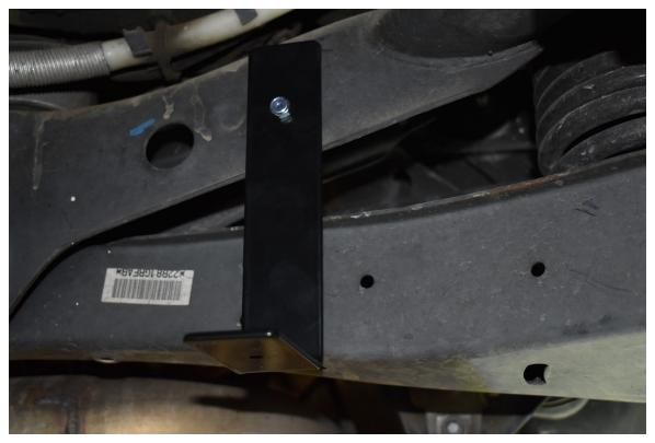
FRONT SIDE OF BRACKET W/ 1.5" OD FENDER WASHER
