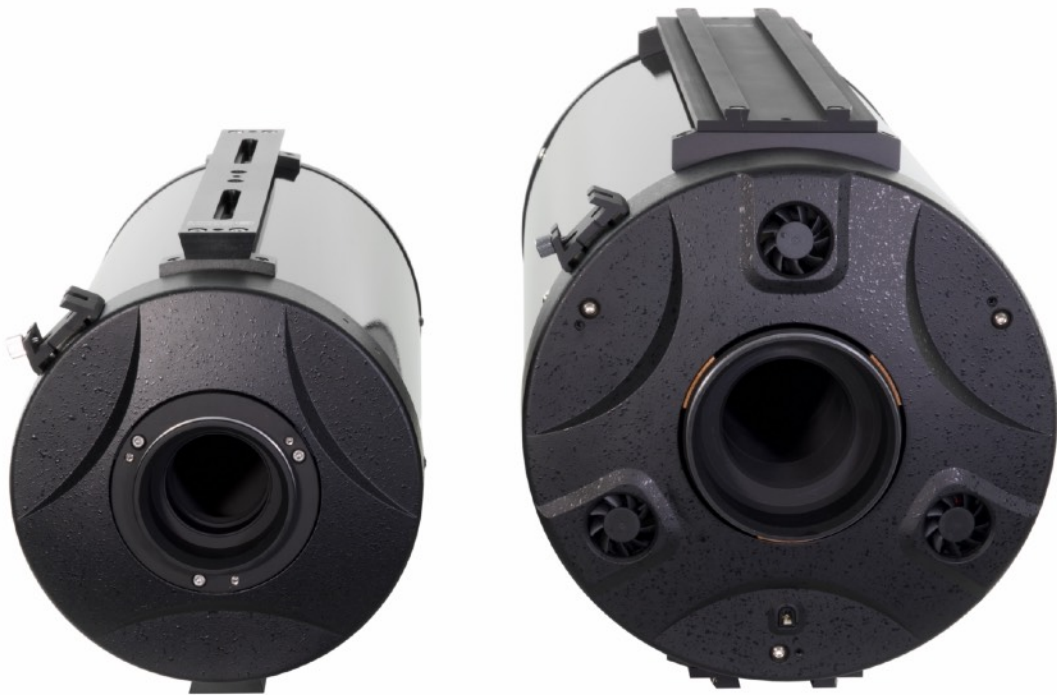
Alla sinistra il filetto 90mm che trovi sui telescopi Ritchey-Chretien GSO da 6" e 8". Alla destra, il filetto da 117mm che trovi sui telescopi Ritchey-Chretien GSO da 10", 12", 14" e 16".
