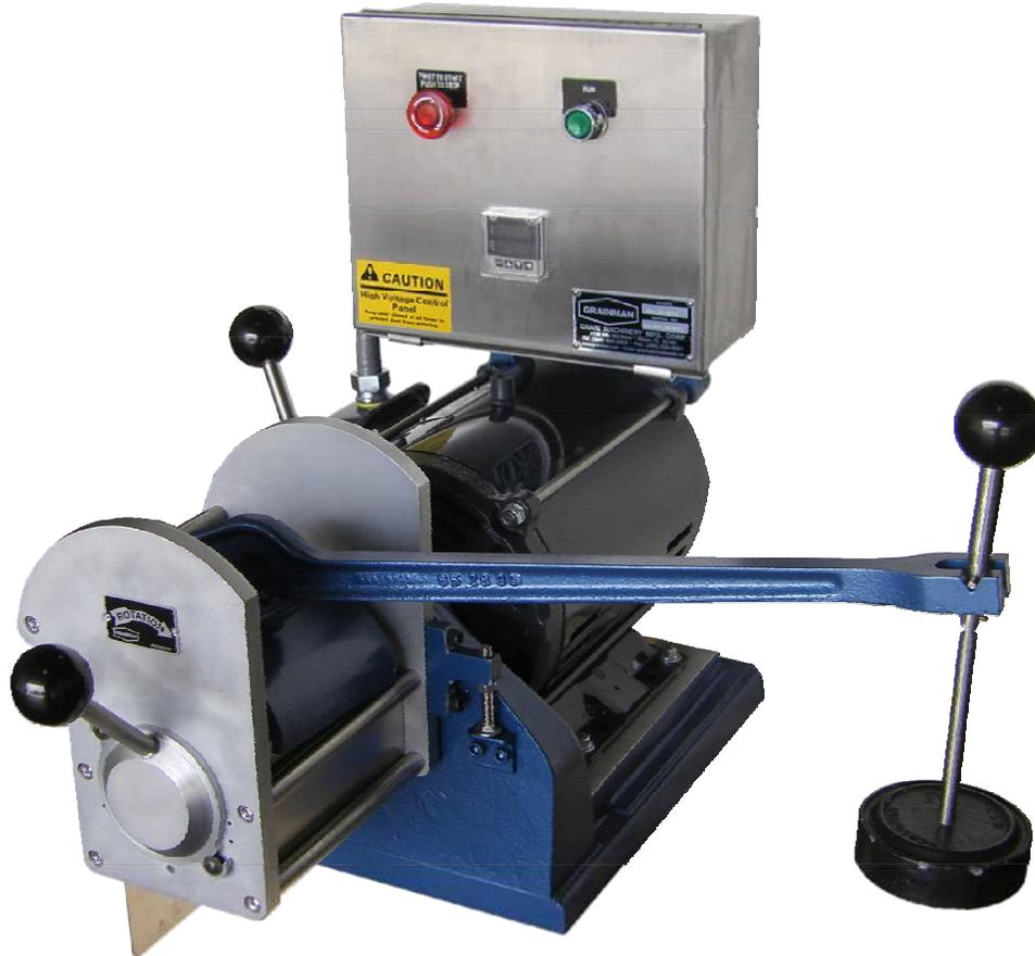
Diseñado para cumplir con los requerimientos de servicio del Departamento de Agricultura de Estados Unidos (USDA) / Servicios Estatales de Inspección de Arroz, el Pulidor de Arroz Grainman Equipo No. 65 proporciona un método rápido, fácil y eficiente de pulido.
