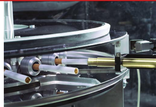
Mit einer Abrauchmaschine werden Nikotin-, Teer- und Kohlenmonoxidwerte gemessen.
