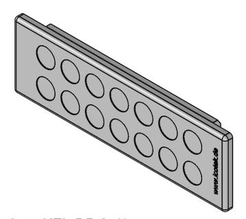
Kabeldurchführungsplatte KEL-DP 24/14 14 x 12,1mm für Blechstärken von 1,5 bis 2,5mm Ausschnittgröße 112x36mm
