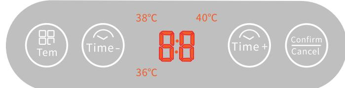
Il pannello di controllo digitale viene utilizzato per impostare la temperatura e la durata durante la preparazione dello yogurt.
