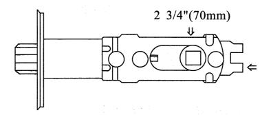
THE LATCH IS SET 2 3/4"(70mm) TO ADJUST TO 2 3/8"(60mm) PULL IN THE REAR PART
