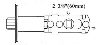
THE LATCH IS SET 2 3/8"(60mm) TO ADJUST TO 2 3/4"(70mm) PULL OUT THE REAR PART
