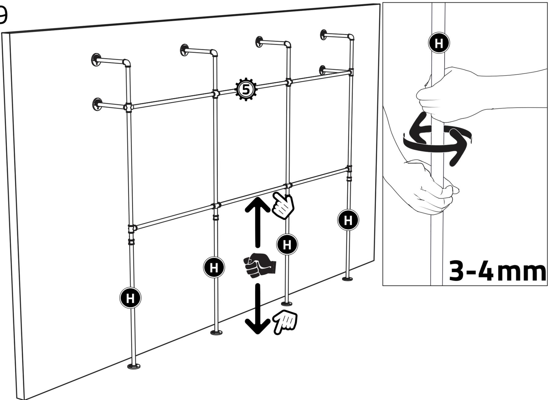
**Zum Schluss Stange H ein wenig herausdrehen und gegen den Boden zu verspannen. Damit erhält man eine zusätzliche Stabilität und gleicht Unebenheiten im Boden aus./**
