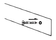
TAP THE PLASTIC ANCHOR(S) INTO THE WALL
