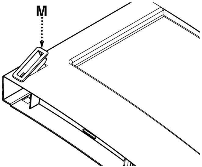
10. Recherchez le logement du boîtier du verrou de la porte droite. Introduisez le boîtier du verrou de porte (M) dans le logement du verrou de porte.
