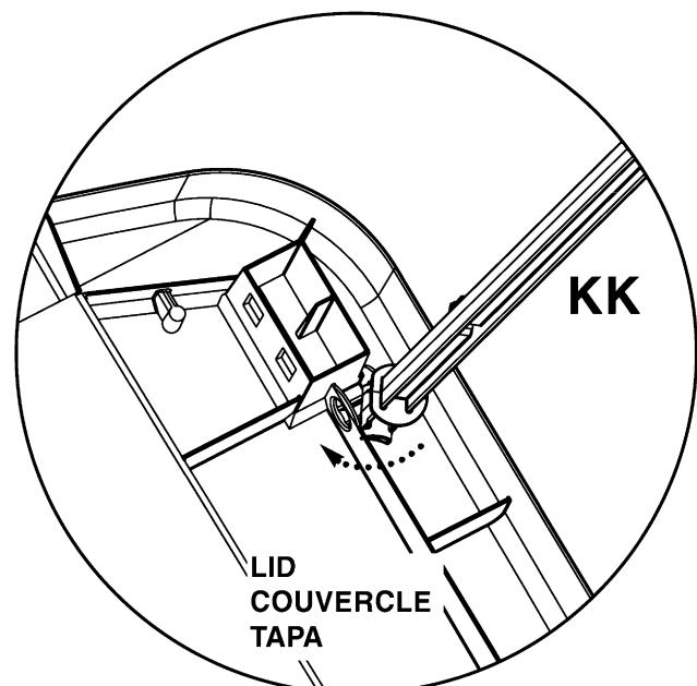
21. Ouvrez le couvercle et trouvez le logement du cylindre situé sous le couvercle dans le coin avant droit ou gauche.
