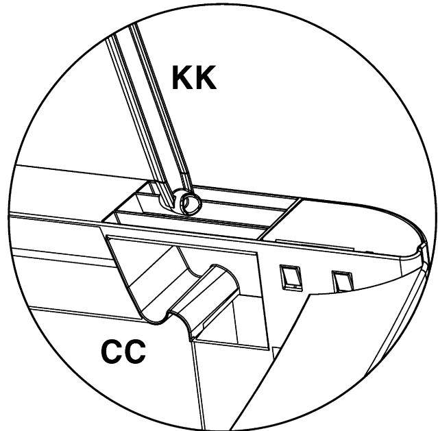
20. Gire la Varilla de Soporte de la Tapa (KK) de manera que el extremo pequeño del cilindro pase a través de la ranura en el borde superior del frente del Panel Lateral Superior (CC o EE pues la Varilla de Soporte puede colocarse en el lado derecho o en el izquierdo).
