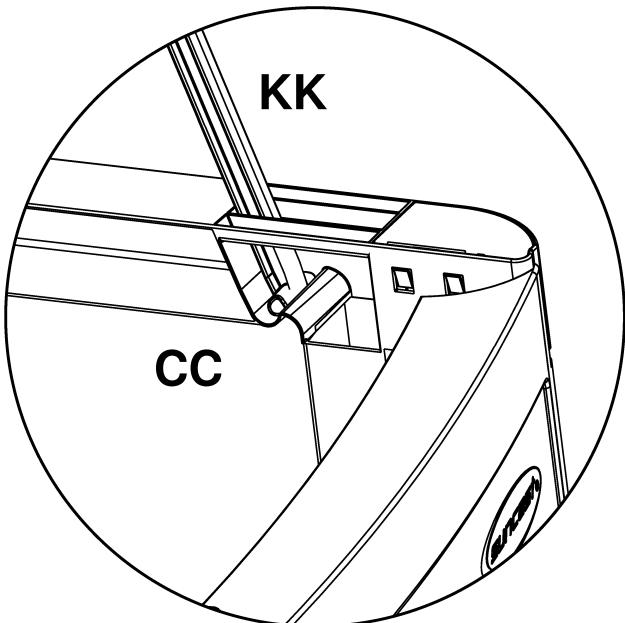
19. Pour utiliser la tige de support du couvercle, ouvrez le couvercle jusqu'à ce que la tige de support se lève et repose dans le logement qui lui est réservé.
