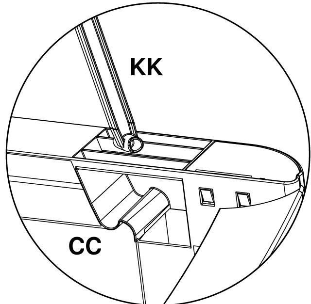
17. Tournez la tige de support du couvercle (KK) afin que l'extrémité du petit cylindre puisse passer dans la fente située dans la partie avant du panneau latéral supérieur droit (CC ou EE car la tige de support peut être placée sur le côté gauche ou sur le côté droit).
