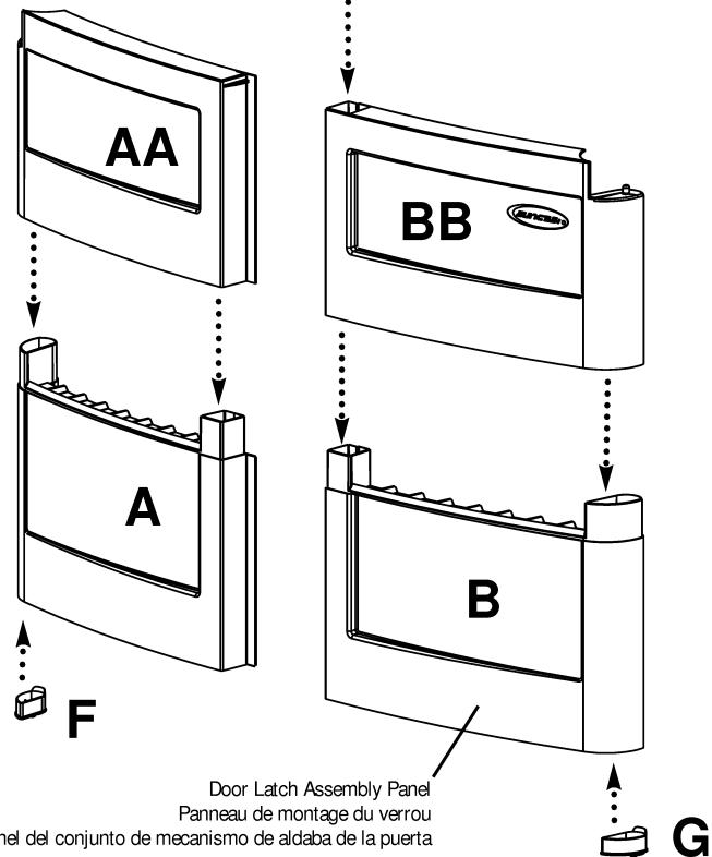
4. Arme las puertas, colocando las Puertas Superiores (AA, BB) sobre las Puertas Inferiores (A, B) y presionando para juntar las piezas hasta estas encajen en su lugar.
