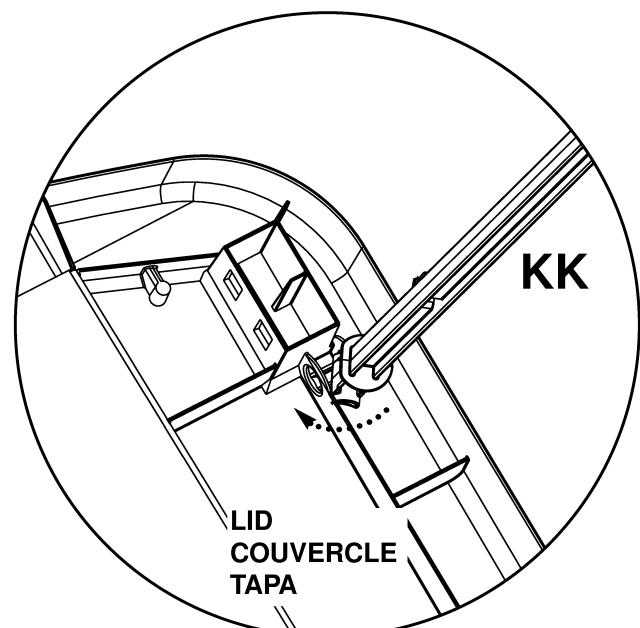
18. Ouvrez le couvercle et trouvez le logement du cylindre situé sous le couvercle dans le coin avant droit ou gauche.
