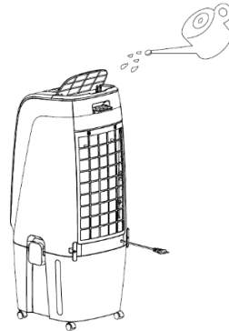
Fill water (Fig. 4)
