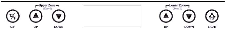
\* Pour régler la température de la zone supérieure, appuyez sur le bouton FLÈCHE VERS LE HAUT ou VERS LE BAS sur le panneau de commande. La température à l'intérieur peut être réglée par incréments de 1 degré entre 40 °F et 50 °F (5 °C à 10 °C).
