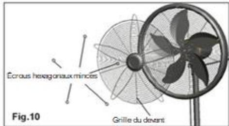
1. Utiliser une clé pour retirer soigneusement les écrous hexagonaux de la grille avant. (Fig. 9)
