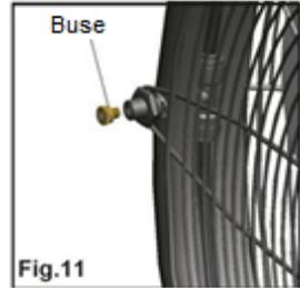
**MISE EN GARDE : Ne jamais nettoyer les buses avec des épingles ou d'autres objets pointus pour ne pas endommager l'appareil.**
