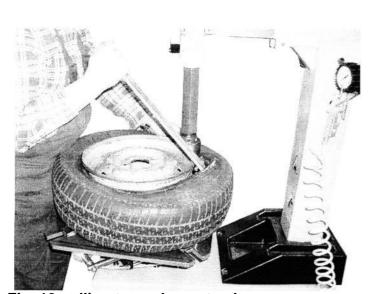
Fig. 10 pulling tyre edge onto shoe
