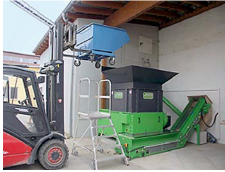
Single-shaft shredder serie EZ 13 with optional angled conveyor.
