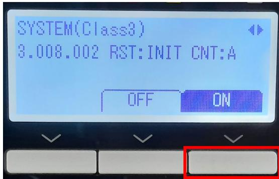
Drücke die Taste unterhalb des Feldes „ON“ (rot markiert). Das Feld „ON“ wird blau hinterlegt.
