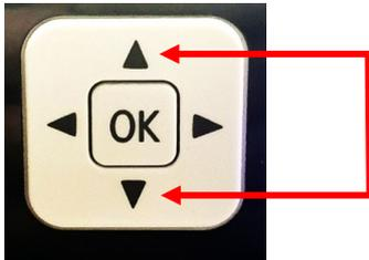
Um in den sogenannten SP (Service) Modus zu gelangen drücke bitte die Pfeiltasten (**RAUF**) und (**RUNTER**) **gleichzeitig** für mind. **7 Sekunden**.
