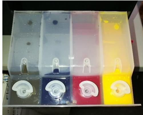
Fermez le couvercle des réservoirs d'encre et mettez-le en place.
