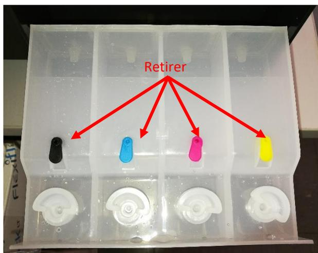
L'étape suivante consiste à remplir les réservoirs d'encre vides. Lors du remplissage des réservoirs, il est essentiel de remplir avec la bonne couleur d'encre le réservoir de couleur correspondant. L'ordre des couleurs va de gauche à droite:
